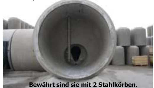
Die Stahlbetonrohre haben einen Innendurchmesser von 2,6 m und eine Wanddicke von 25 cm.
