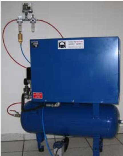
Steuerluftkompressor m. Schalldämmung
